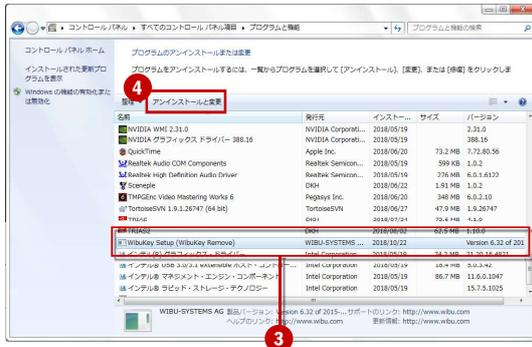
リストから [ WibuKey Setup (WibuKey Remove) ] ( 3 ) を選択し、[ アンインストールと変更 ] ( 4 ) ボタンをクリックします。
